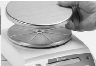
3) Installazione del vassoio
