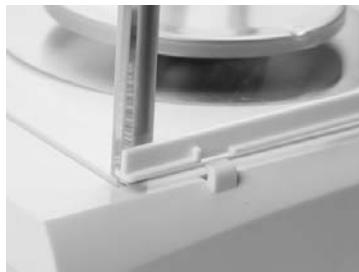
1) Installazione degli sportelli laterali – Inserire completamente nel telaio superiore e poi spingere in basso sul fermo.
