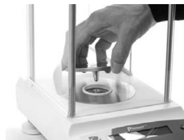
4) Installazione del vassoio
