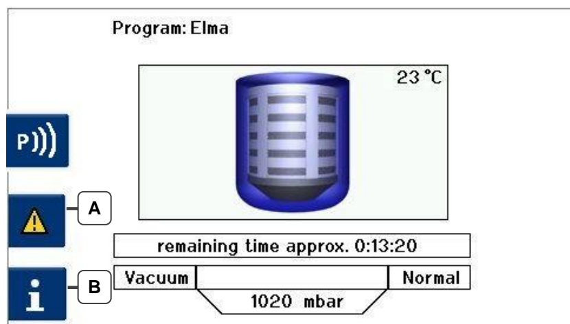
Fig. 11.1.1 Display Fault message (example)
